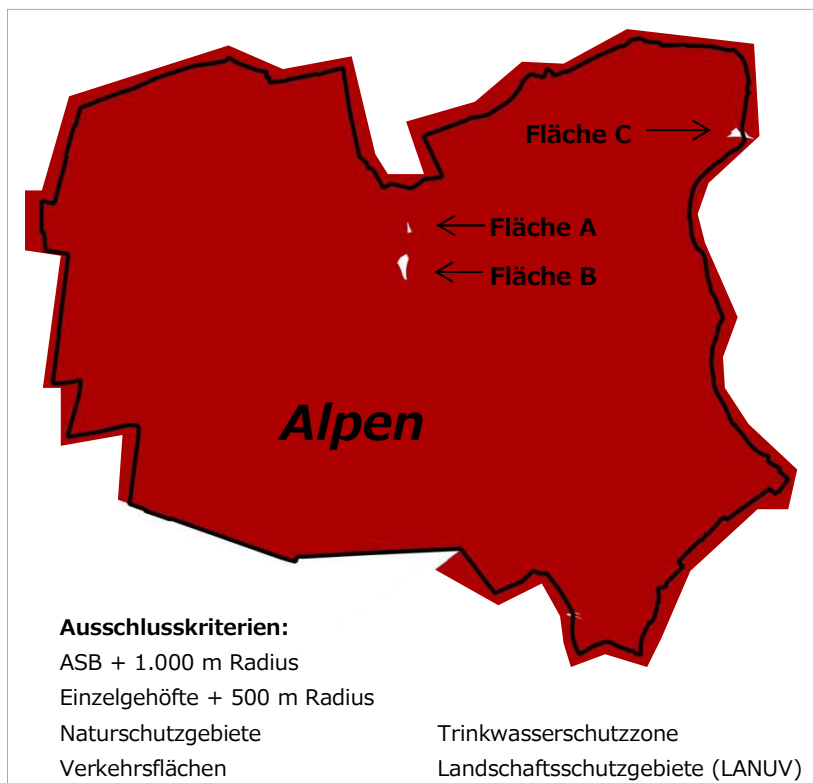
Abb. 4: Ausschlussbereiche für Windenergieanlagen mit Höhe 150 m
